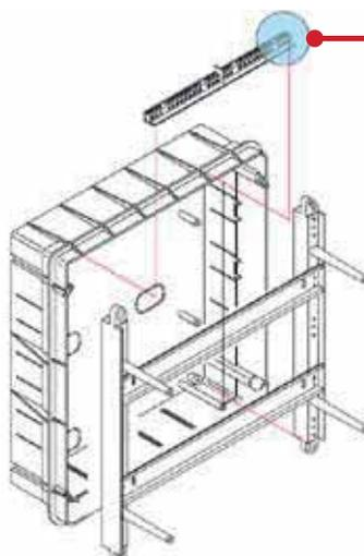
**Possibilità di alloggiamento morsetti T/N su entrambe le testate**
